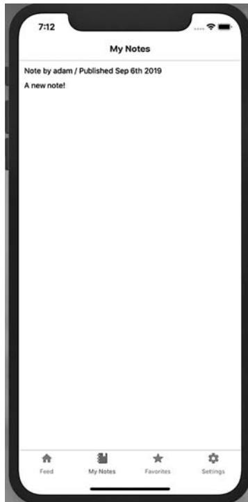
Рис. 24.4. Передача токена в заголовке каждого запроса позволяет выполнять в приложении индивидуальные пользовательские запросы
