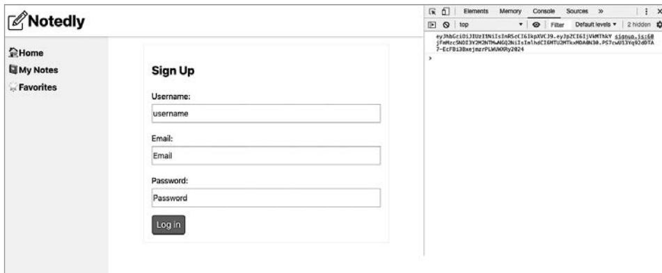
Рис. 15.1. В случае успеха при отправке формы в консоль будет выведен JSON Web Token
